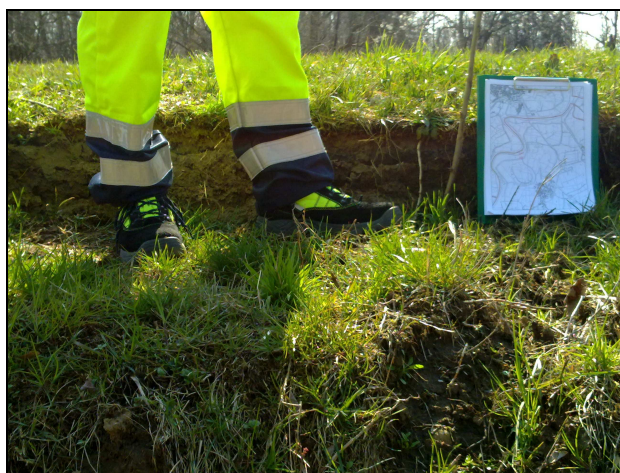
Foto 6: particolare del ribassamento (il foglio bianco è un A4)
