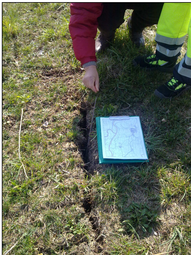
Foto 5: crepacciatura e ribassamento
