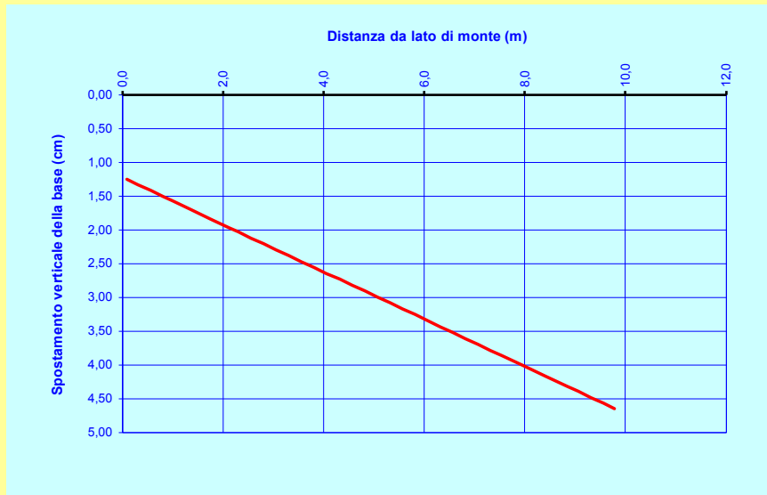
FIG.10 - Spostamento verticale alla base del pozzo
