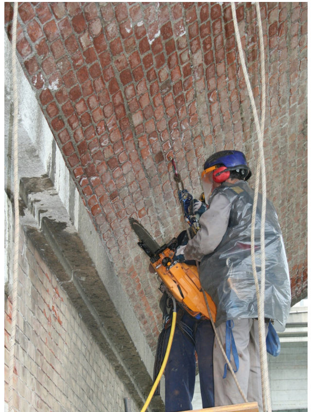
Fasi di esecuzione della prova con martinetto piatto M5
