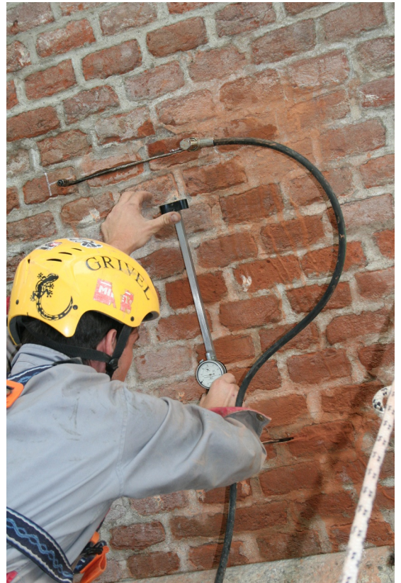
Fasi di esecuzione delle prove con martinetti piatti M1 e MD1
