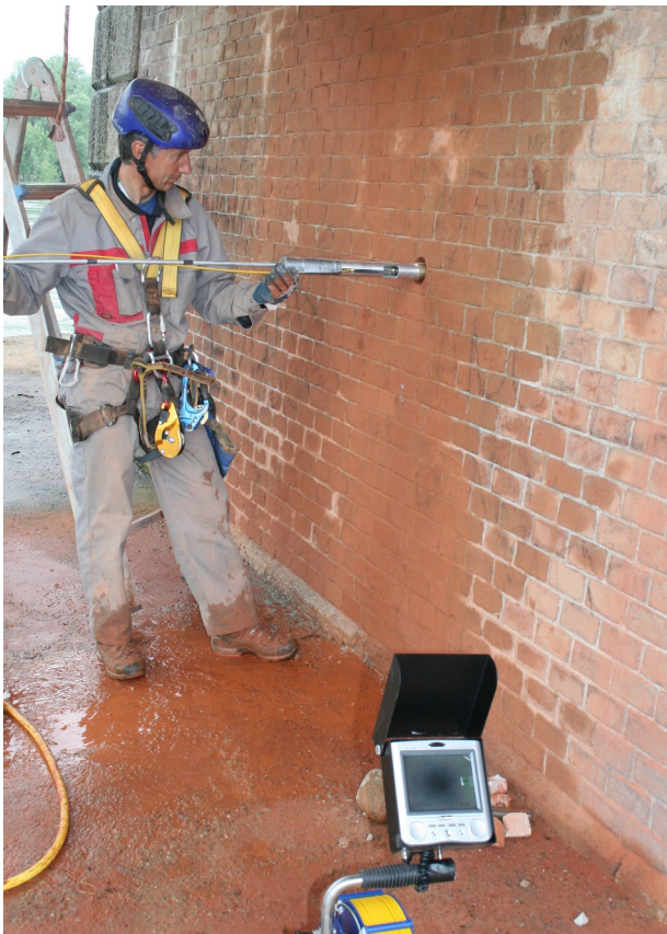
Ispezione con sonda televisiva nel foro del carotaggio C1 e ripresa fotografica delle fasi di preparazione delle prove nella pila 3
